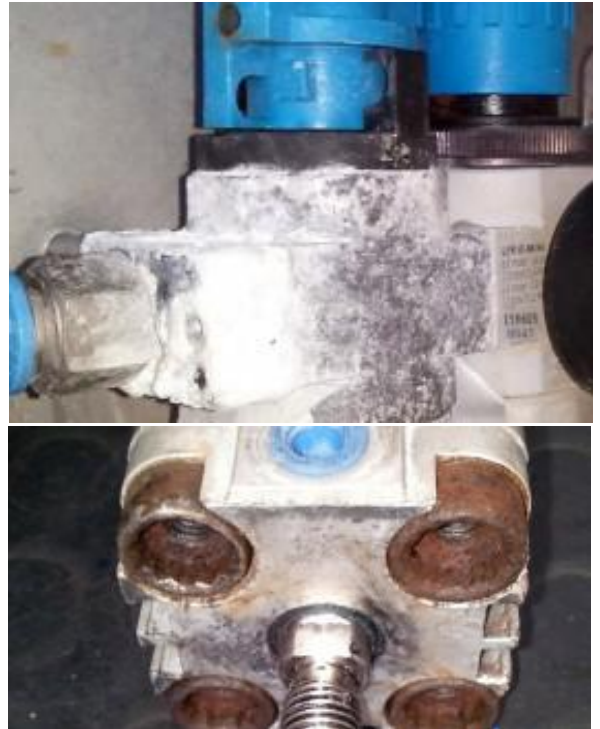
材料选择不正确——典型的损坏剖面
